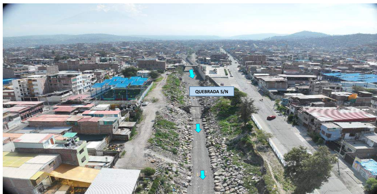
IMAGEN 03: EN ESTE TRAMO SE OBSERVA EN LA QUEBRADA S/N, SEN ENCUENTRAN SIN PROTECCION EN AMBAS MÁRGENES; SOLO ROCA SUELTA EN SUS TALUDES; VISTA DE PLANTA MEDIANTE DRON
